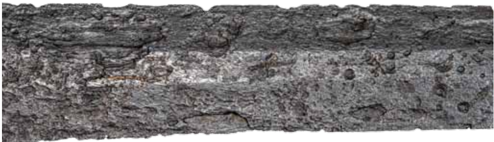
Abb. 14 Detail der Klinge Links die in Buntmetall ausgeführte Wolfsmarke, rechts die Reste einer Bischofskrümme (Bayerisches Armeemuseum, Inv.-Nr. A 3940)
