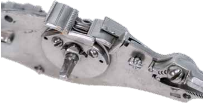
Abb. 12 Durch Druck auf den rosettenförmigen Knopf kann der Deckel der Pfanne geöffnet werden.
