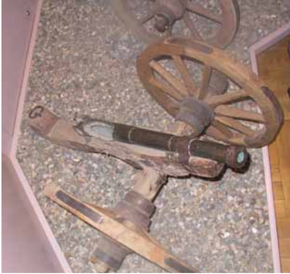
Abb. 16 Schwere, provisorisch auf eine spätere Radlafette montierte Büchse, die durch eine massive Kammerausprengung irreparabel beschädigt wurde. (NordJURA-Museum Weismain, Bayern)
