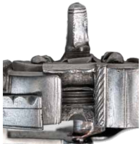
Abb. 9 Blick durch den Ausschnitt der Pulverpfanne auf das gerillte Rad
