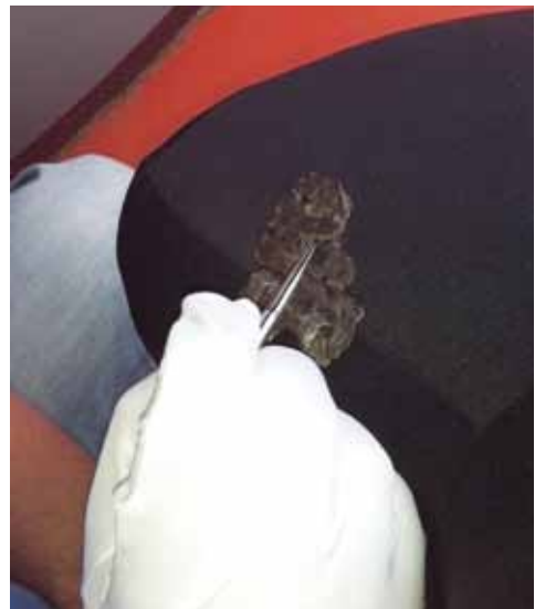
Abb. 25 Entnahme einer Materialprobe der Rüstung zur Untersuchung mit einem Rasterelektronenmikroskops am Anwenderzentrum Material- und Umweltforschung der Universität Augsburg
