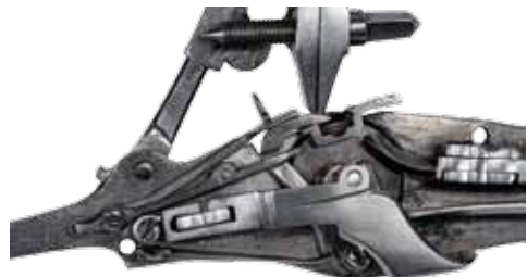
Abb. 13 Der auf das Rad herabgesenkte Hahn, in dessen Hahnlippen ein Pyrit (Schwefelkies) geklemmt wurde (fehlt hier).
