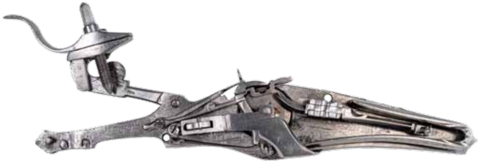
Abb. 10 Innenseite des Schlosses Rechts ist die V-förmige Spannfeder zu sehen, die mit der Kette verbunden ist. Die Kette ist hier durch den so genannten Radbügel verdeckt.
